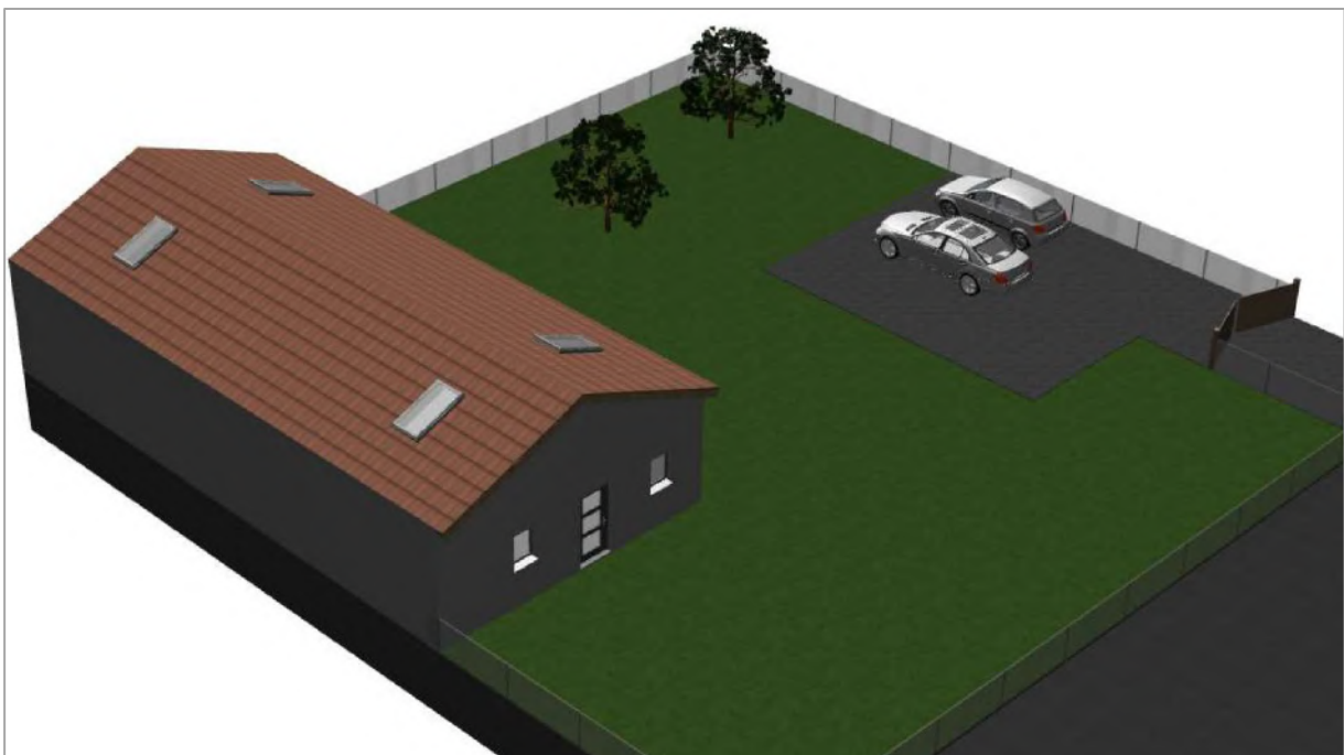
Construction non conforme au règlement modifié (pan de toiture non aveugle)
