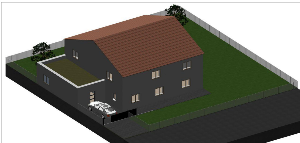
Toit végétalisé en limite autorisé car non accessible
