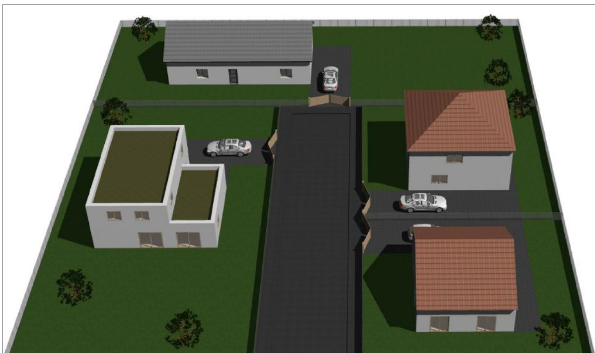
Voie en impasse en lotissement laissant une marge de sécurité pour le stationnement des véhicules à l'intérieur des lots
