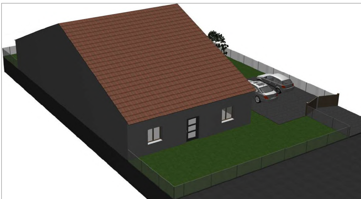
Mur pignon en limite séparative (situation autorisée par le règlement)
