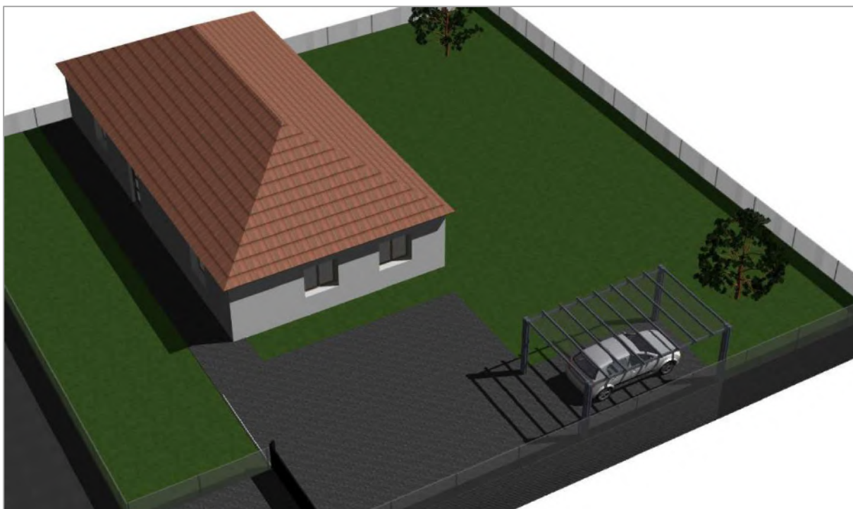
Carport en limite séparative (non autorisé par le règlement)
