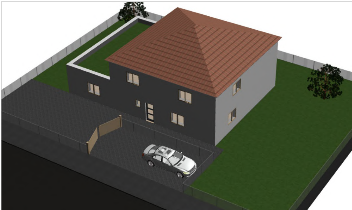
Portail implanté perpendiculairement à la voie (non conforme aux règles applicables)
