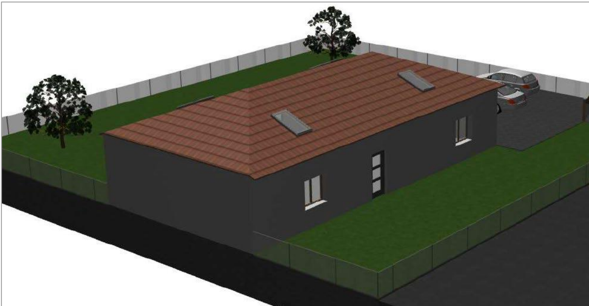
Absence de mur pignon en limite séparative (situation contraire au règlement)
