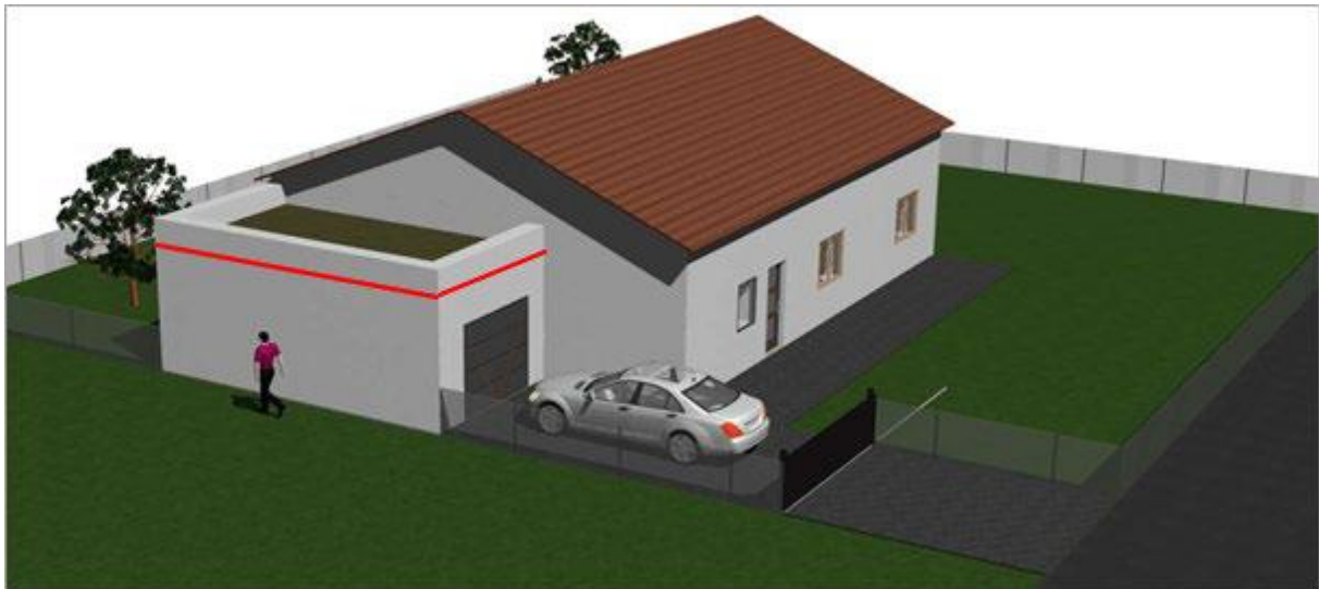
Construction d'un garage en limite séparative (hauteur de 3m50 en bas de l'acrotère)
