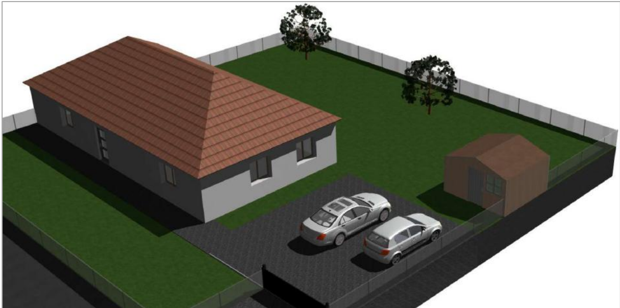
Implantation d'un abri de jardin non autorisée (absence de mur pignon en limite séparative)
