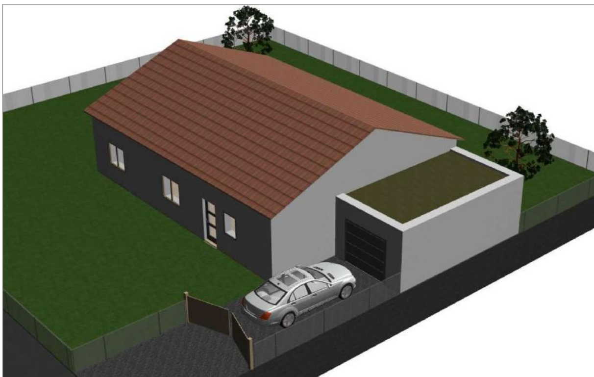
Toit plat végétalisé en limite séparative (situation contraire au règlement)
