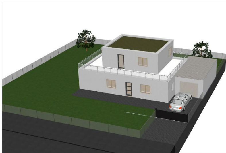
Construction cubique comprenant un toit végétalisé, un toit plat en limite et une unique toiture terrasse accessible
