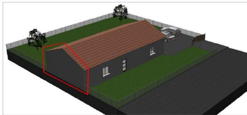
Structure imposée par le règlement en l'état : mur pignon sur la limite séparative
